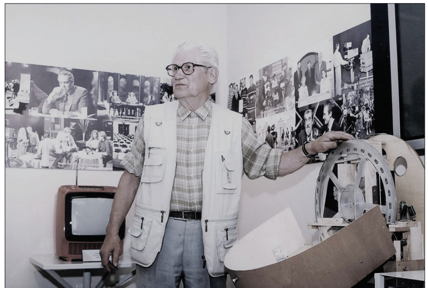
Mati Tähemaa Eesti Ringhäälingumuseumis tutvustamas enda ehitatud Nipkowi kettaga „kaugnägemisseadet“. Foto: Eesti Ringhäälingumuseum, 2005.
