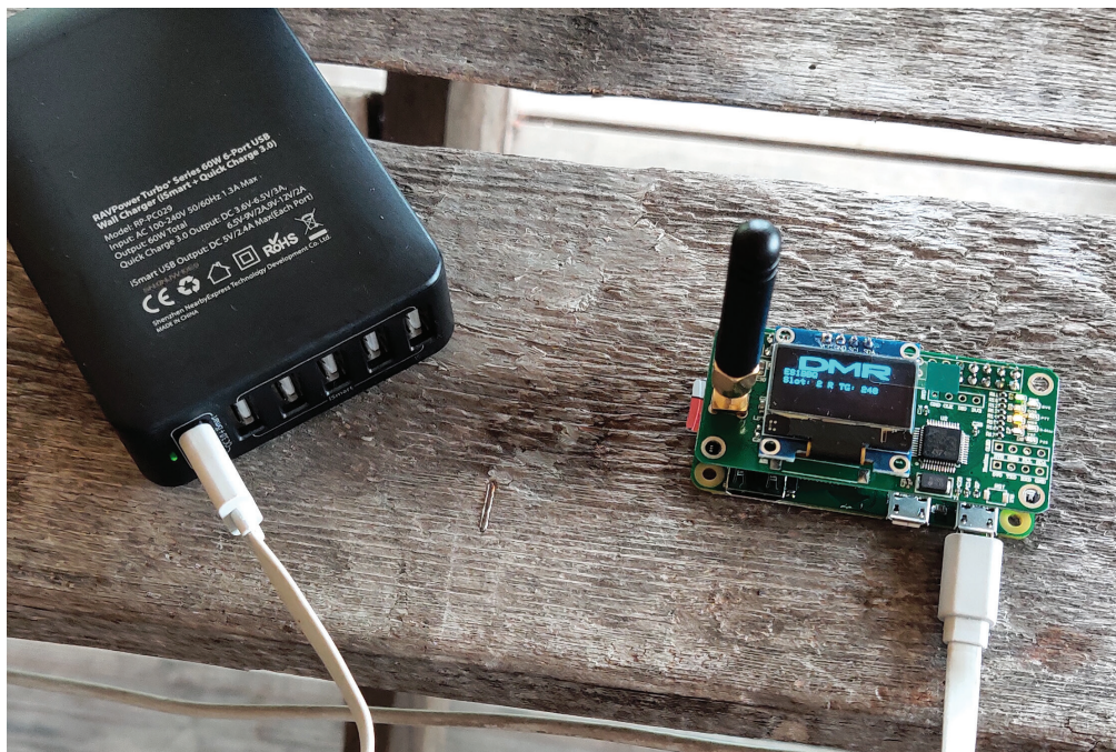
DMR-hotspot: MMDVM ja Raspberry Pi Zero.
