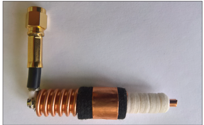
Eksperimentaalne 5G bändi antenn (ES1ABU töö)
